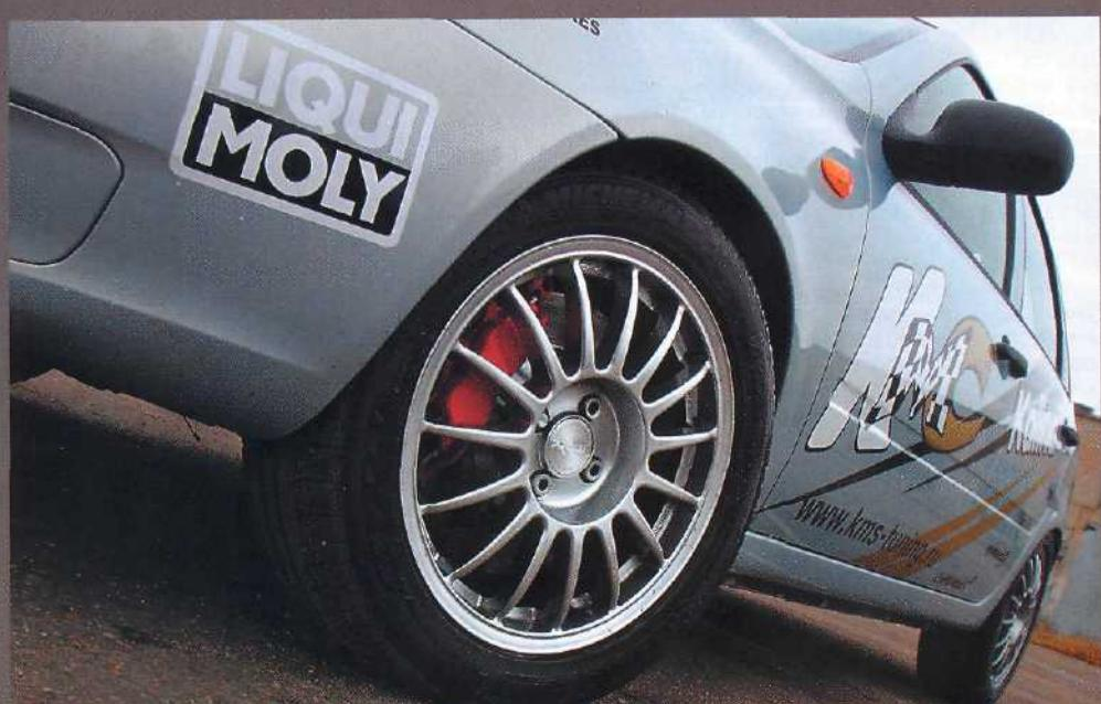
С большими 16-дюймовыми колесами Калина лучше тормозит и поворачивает, но для почти стандартного мотора они слишком тяжелые
